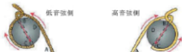
\* 弦を張り終わったら、余った弦をストリング・ポストの付近で短く切り、先端を内側に折り曲げるなどして安全を図ってください。
