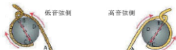
こうしておけば、チューニング・キーを回すことにより、弦は自らストリング・ポストに強く固定されるようになり、スリップによる弦の緩みなどのトラブルを避けられます。
