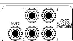
M6 CARBINE(カービン)のファンクション・ジャックは、通常市場で販売されている、シンプルなグランド(チップ・トゥー・グランド)の、ラッチング(モーメンタリーではなく)タイプのスイッチを使用して下さい。
