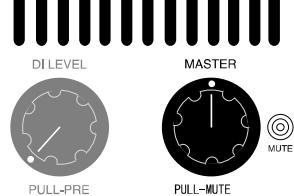
ノート: **MASTER(マスター)**コントロールは、車のアクセル・ペダルに相当する強力なコントローラーですので、操作には注意が必要です。スピーカーや耳に損傷を与えない為に、最初は絞りきった状態から始めて下さい。
