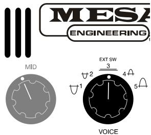
にせず、それぞれのサウンドの特徴を掴んでしまえば良いのです。5ポイントのロータリーファンミで、サウンドを聴きながら選択するだけです。サウンドが大きく変化するのは、主に中音域なので、サウンドのキャラクターが劇的に変化するのです。5つのポイントの内、左側の2つは中音域を減衰させ、右側の2つは中音域を増幅させます。それぞれの周波数特性は、5ポイントのロータリーファンミの周囲にグラフィック表示されており、一目見るだけで解る様に工夫されています。残りの1つ(3番目のポジション)は変化させず、VOICE(ボイス)機能をバイパスします。機能的な事を詳しく知らなくても、グラフィックを見ただけで直感的に操作する事が出来ます。
