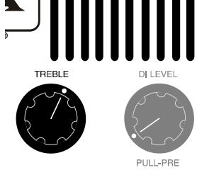
このコントローラーが12時を過ぎると、723Hzを出発点にして、1オクターブに付き6dbずつ、+20dbに達するまでゲインが上がります。723Hzよりも上の周波数は、+20dbに達すると20Khzまでそのゲインを保持します。これは、従来のパッシブ・コントロールの良さを生かしつつ、さらにサウンドに甘さを加える働きをしています。このコントロールを12時よりも下げる時、3.2Khzからシェルビング・ポイントの723Hzにかけて、1オクターブに付き6dbずつゲインが下がります。723Hzよりも上の周波数は、-20dbに達すると、コントローラーを7時半にするまでそのゲインを保持します。この周波数帯域を減衰させる能力は、信じられないほど豊かで暖かみのある、懐かしのR&Bやジャズ・サウンドを再現する事を可能にしています。
