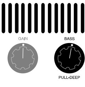
BASS(バス)コントロールで、実際にゲインをコントロールする時のロール・オフ周波数は、55Hzになっており、その上下の倍音成分も一緒にコントロールします。このコントローラーが12時を過ぎると、321Hzをピークにして、1オクターブに付き6dbずつゲインが上がります。12時になると“平”(増幅も減衰もしません)になります。BASS(バス)コントロールを12時よりも下げる、55Hzまでの音域と、その倍音成分が減衰したサウンドになり、55Hzから20Hzの音域が、1オクターブに付き6dbずつゲインが下がります。コントローラーを7時半にすると-20db(オフ)になります。
