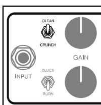
と比べて、信号のコンプレッションのかかり具合が最も少なくなっています。それは、このモードのゲイン構造が伝統的な手法に基づいているからです。これにより、多くのプレーヤーは、Express(エクスプレス)に往年のアンプのようなレスポンスを感じる事でしょう。ハイ・ゲインの設定になると、このモードは懐かしのリード・サウンドを生み出します。オーバードライブが手放せないプレーヤーには、このモードよりも他の3つのモード、特にBLUES(ブルース)モードをお勧めします。CLEAN(クリーン)モードは広いダイナミック・レンジを必要とするプレーヤーに向いています。
