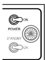
これは、*Express*に電源を供給するためのスイッチです。電源のアースがとれている事を確認して下さい(これは、アンプのみならず、演奏者の安全の為にも重要な事です)。また、コンセントに適正な電圧が供給されている事を確認して下さい。
