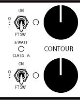
ミニ・トグル・スイッチはチャンネル選択スイッチと同様の動作をします。; ON(上)にするとCONTOUR(コントゥア)機能がオンになり、OFF(真ん中)にするとオフになり、FTSW(下)にするとフットスイッチで切り替えられる様になります。
