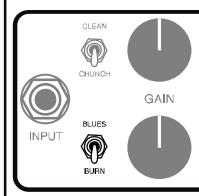
その理由は、メディアム・ゲイン・リードの回路構成にあります。このモードでは、GAIN(ゲイン)コントロールを低い設定値にしても、CLEAN(クリーン)モードより暖かみがあり太いサウンドを生み出す事が出来ます。ですから、BLUES(ブルース)でクリーン・サウンドの設定をしたい場合は、チャンネル1をCRUNCH(クランチ)モードにしてリード・サウンドが出せる様にしておいて、チャンネル2をBLUES(ブルース)モードでクリーン・サウンドを出すのが良いでしょう。この時、ゲインは低め(9時半)、トレブルを高め(1時半から2時)、そしてミッドは低め(8時から9時半)に設定して下さい。
