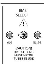
デュアル & トリプル・レクティファイ・ヘッドアンプは、様々な用途に使用出来る様に設計されています。その為、信じられない程多くの機能が用意されています。このアンプのパワー・セクションには、往年の英国スタイルの5極パワー管、EL 34が採用されています。この真空管の大きなレスポンスは、大英帝国で制作された、多くの素晴らしいアンプのサウンドを特徴づけており、今日でも、多くのレコーディングで使用されています。そのサウンドの特徴は、高音域の明るさにあります。
