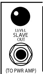
このフォーン・ジャックとコントローラーは、スピーカー・ジャックへの信号を出力する事が出来ます。このジャックに、他のパワーアンプ(デュアルあるいはトリプル・ヘッド)を接続して、RECTO(レクト)を、マスター・プリアンプとして使用する事が出来ます。また、SLAVE(スレーブ)を、エフェクト・プロセッサーに出力して、エフェクト・プロセッサーの出力を他のアンプに接続するという、使い方も可能です。
