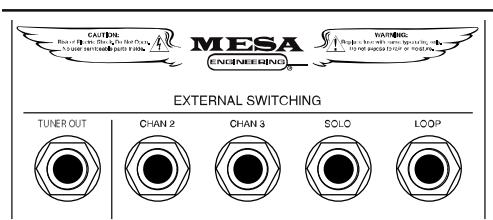
このジャックにスイッチを接続する事により、そのスイッチでアンプをコントロール(通常はMIDIでプログラムします)する事が出来ます。どのスイッチも、フォーン・プラグの“チップ”と“リング”を内部で“ショート”させる事によって動作させます。
