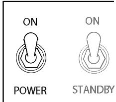
これは、DUAL/TRIPLE RECTIFIERに電源を供給するためのスイッチです。電源のアースがとれている事を確認して下さい(これは、アンプのみならず、演奏者の安全の為にも重要な事です)。また、コンセントに適正な電圧が供給されている事を確認して下さい。
