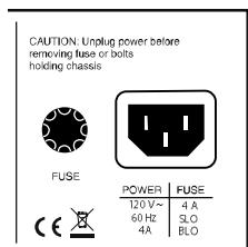
これは、メイン・ヒューズです。ヒューズは、外的要因による電源の過大入力からパワー管を保護する役割を担っています。ヒューズを交換する場合は、Slow-Bloタイプの同じ規格のものを使用して下さい。度々パワー管がショートしたり破損したりする場合は、ヒューズがとんでいる可能性が高いのでチェックして下さい。ON/STANDBY(スタンバイ)セクションの説明に従ってスタンバイ・スイッチをオンにしてもパワー管が正常な動作をしない場合は、即座にスタンバイ・スイッチをスタンバイに切り替えて、パワー管を交換し必要であればヒューズも一緒に交換して下さい。
