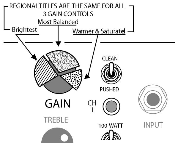
ほとんどのギター・アンプ、とりわけ全真空管回路においては、プリアンプのGAIN(ゲイン)コントロールが最も重要なコントローラーになります。GAIN(ゲイン)コントロールは、全体のスタイル、そして、クリーン・サウンド、オーバードライブ・サウンドといった、サウンドのキャラクターを決定づける役割を担っています。RECTO(レクト)において、GAIN(ゲイン)コントロールは、さらに強力です。GAIN(ゲイン)コントロールは、ドライブの量を決めるだけでなく、トーン・コントロール全体を決定づける役割を担っているのです。
